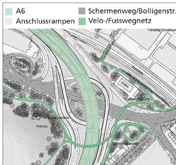
Layout des ausgebauten Anschluss Wankdorf mit Netz für den Langsamverkehr.
